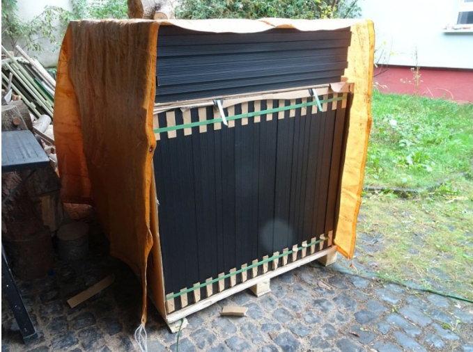
Bild: Der Stapel der 40 Photovoltaik-Module je 320 Watt peak zur Ausgabe in Roßdorf
