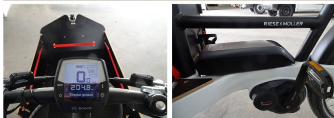
Bild: Elektro-Lastenräder, hinten von Riese und Müller und vorne von Babboe mit Details (Anzeigeelement sowie Batterie und Mittelmotor an der Tretkurbel von Riese und Müller)
