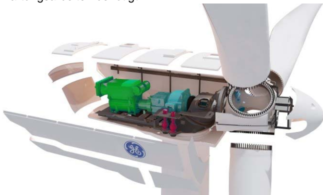
Bild (© GE): Die Gondel der Windkraftanlagen vom Typ GE 2.5-120, von rechts: Rotornabe (mit Schrauben für verstellbare Rotorblätter, Gondel mit Nabenlagerung und Maschinenträger (grau), Getriebe (blau), Nachführmotore (rot) und Generator (grün)
